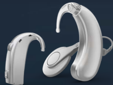
Oticon Dynamo en een cochleair implantaat. Bij een bimodale aanpassing wordt het ene oor elektrisch gestimuleerd en het andere akoestisch.
